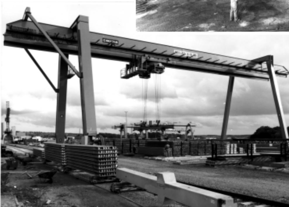
2-balks helpportalkran 2 x 10 tons last. Spännvidd 30 m plus överhäng 2 x 7,5 m. Totalhöjd kran 15 m. Kranen med kundanspassat lyftok med motordrivna elåkvagnar.
