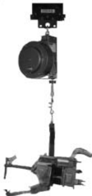
Upphängning av punktsvets i balansblock typ LA
