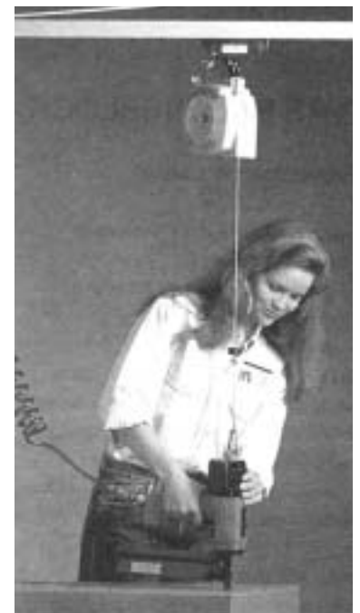
Upphängning av häftpistol i balansblock typ BF
